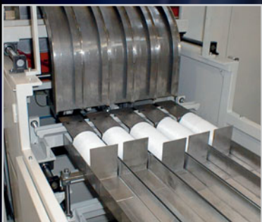
Particolare del gruppo evacuazione prodotto finito a canali fissi. Detail of the stacking unit of formed parts.
