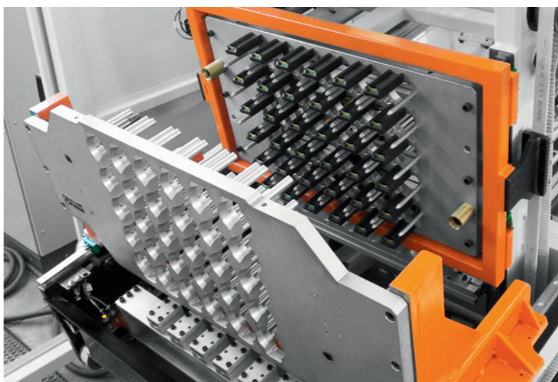
Impilatore a 4 assi (brevettato) 4-axis stacker (patented)
