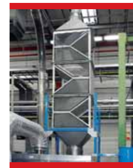
Separatore tappi/etichette Cap/label separator
