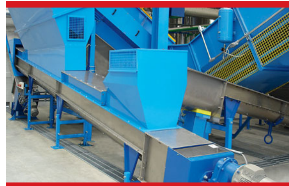
Raccolta scarti centralizzata Centralized waste collection
